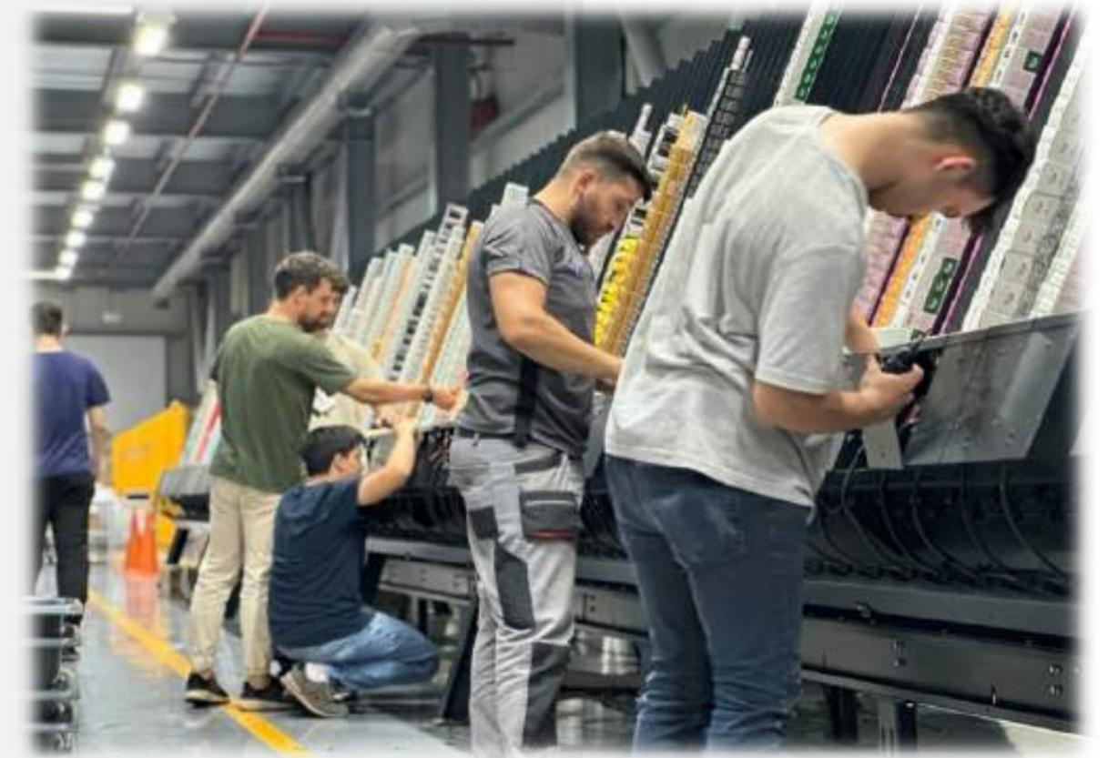
Das vollautomatische Kommissioniersystem T-Pick hat eine Kommissionierkapazität von 1800 Aufträgen pro Stunde. Wenn wir davon ausgehen, dass jeder Auftrag durchschnittlich 25 Produkte enthält, können wir daraus ableiten, dass es durchschnittlich 45.000 Produkte pro Stunde kommissionieren kann.
